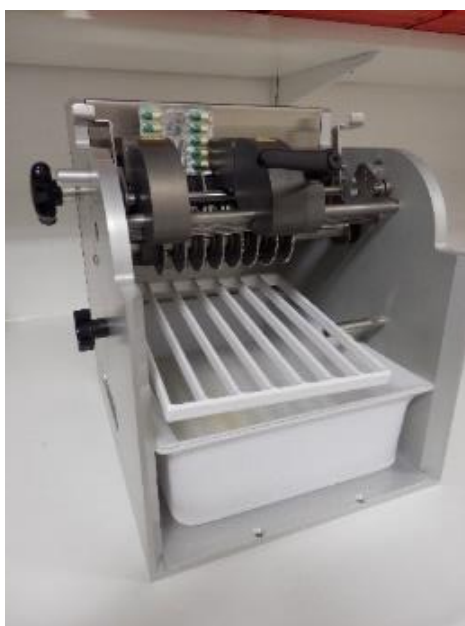
Figure 42 : Exemple de machine à déblisterer (photo prise dans une pharmacie de Normandie)
