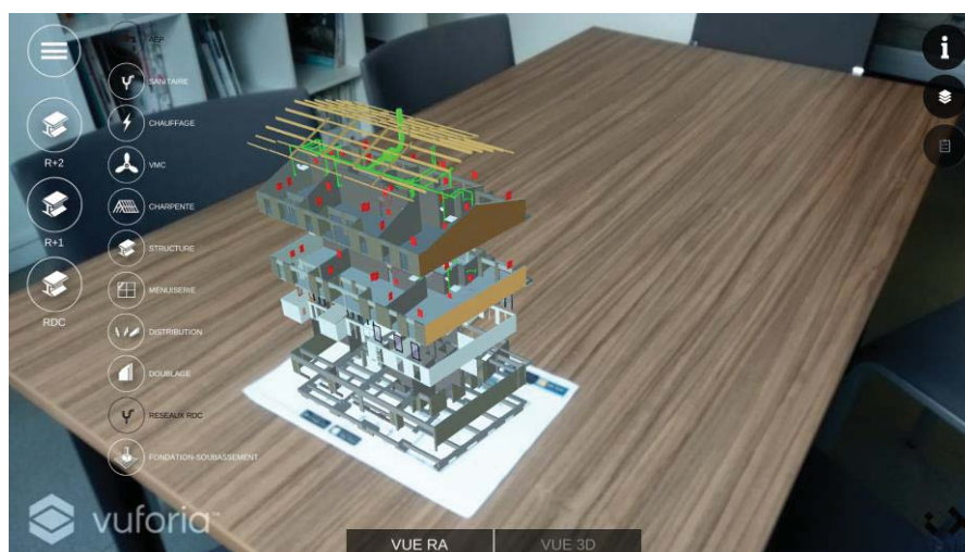
Figure 17 : Capture de l'application de BloclnBloc d'une maquette numérique en réalité augmentée, plan papier présenté en réunion servant de repère physique réel. J.Martin. 2017.
