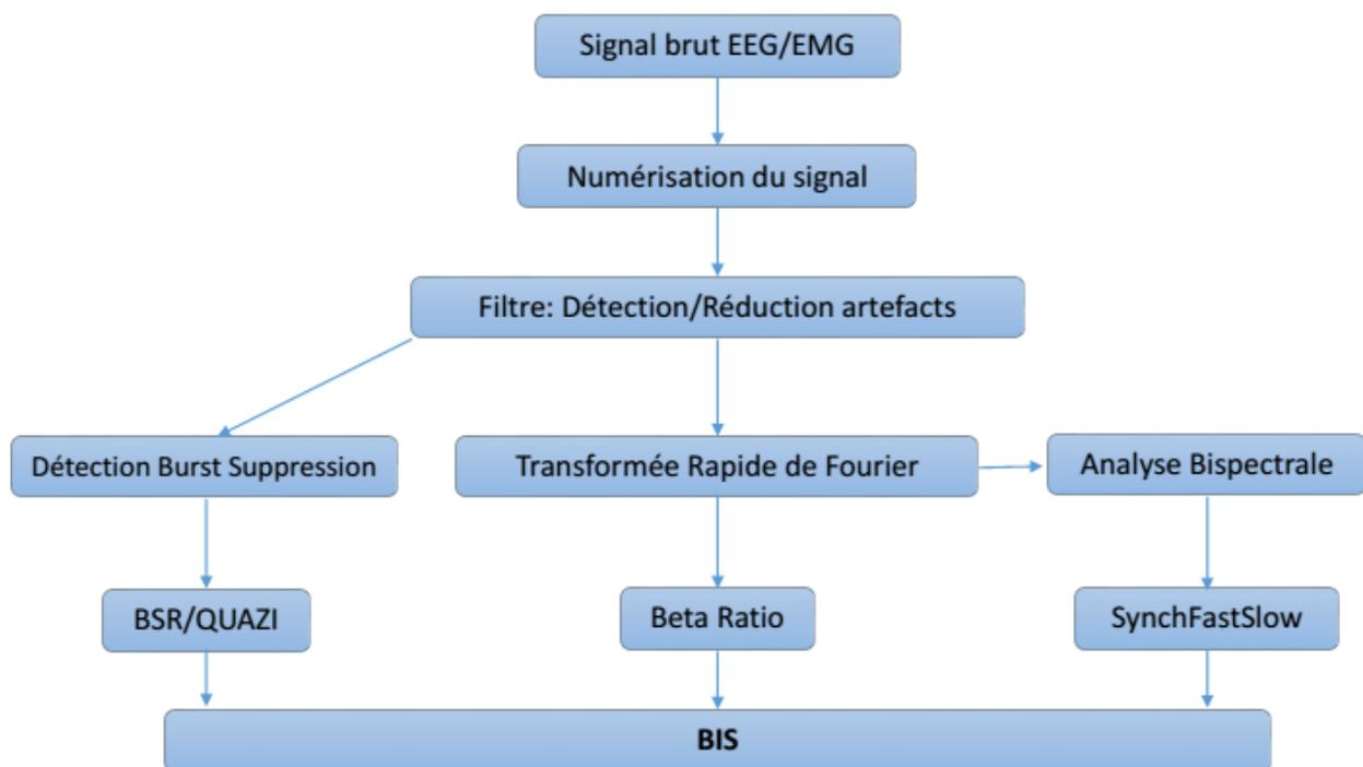
**Figure 3** : algorithme de calcul du BIS
