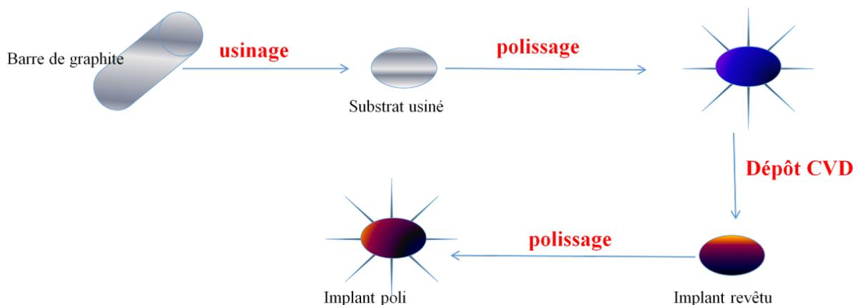
Figure 1 cycle de fabrication d'un implant en pyrocarbone
