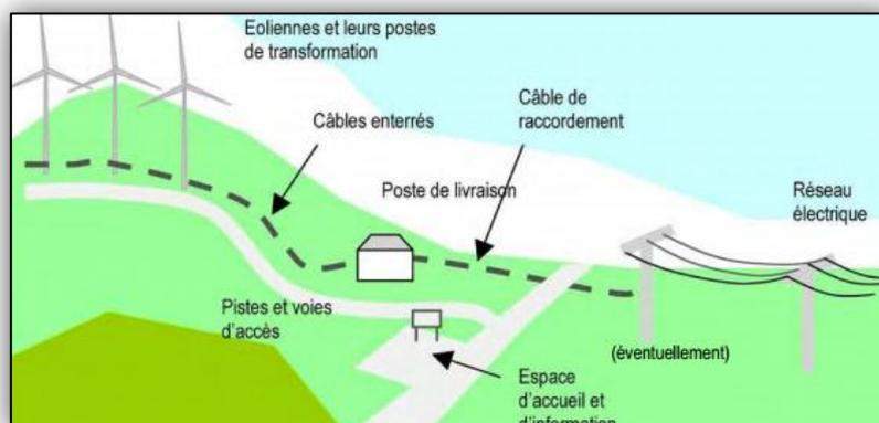
Figure 2 – Schéma descriptif d'un parc éolien terrestre
