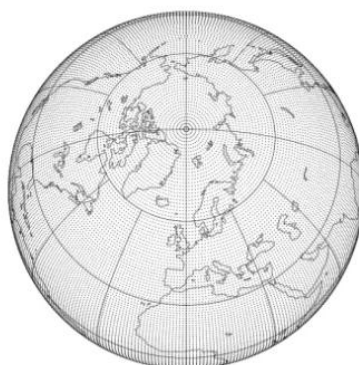
Figure 7: Résolution horizontale de la grille gaussienne réduite N80 des ERA40 pour l'hémisphère nord
