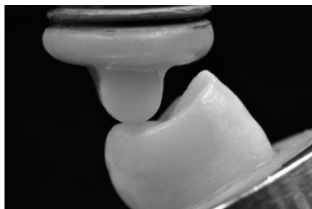
Figure 31 : la mise en charge est faite par le biais d'une cuspidie artificielle en composite selon une inclinaison de 30 degrés
