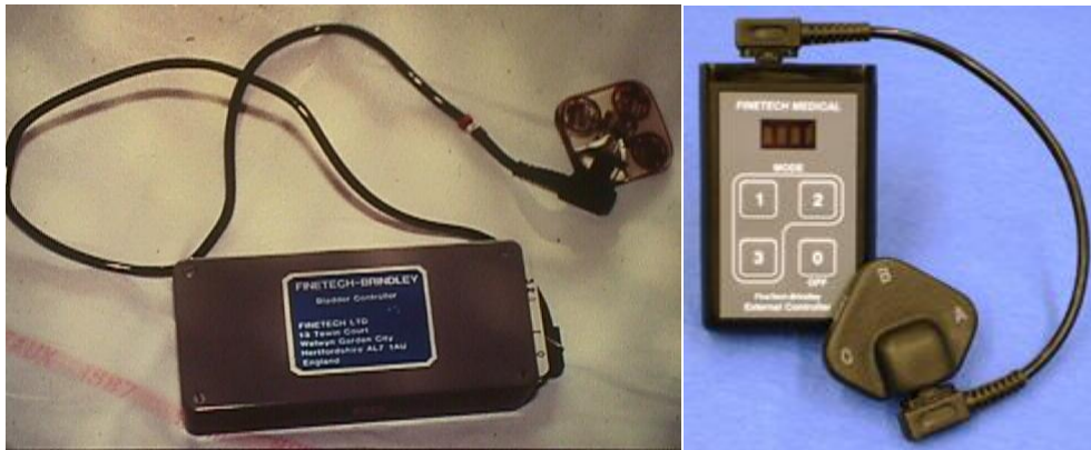
Figure 5 : Boitier Externe Emetteur 1ère et 3ème génération
