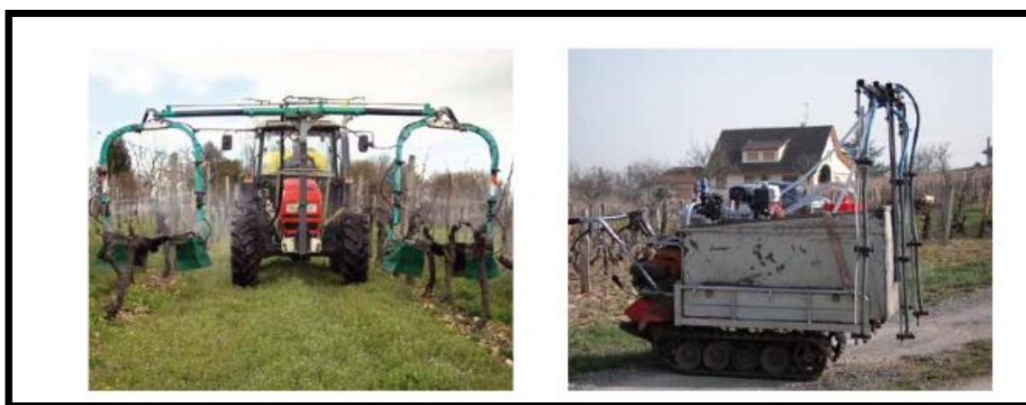
Figure 83 a) et b) : a) Rampe à jets portés; b) Rampe montée sur chenillettes pour les passages dans les vignes étroites (site n°99).
