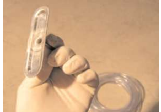
Figure IV.16. Injecteur plat ou cavalier (photo Freyssinet).
