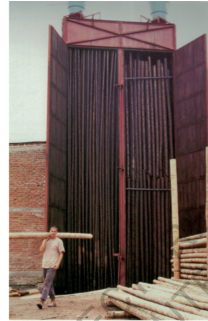
Four pour enfumer les chaumes en Arménie, développé par Antonia Giraldo en 1999. (Vitra 2000)
