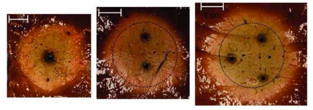
**Figure 9**: Illustration de destruction thermique par micro-ondes ex-vivo par 1, 2 et 3 antennes, puissance 90 W durant 5 minutes. Synergie thermique entre les antennes
