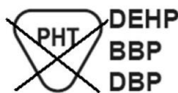
Figure 20 : Symbole défini par la norme NF EN 15986 signifiant la présence de phtalate, dont l'abréviation est mentionnée (37)
