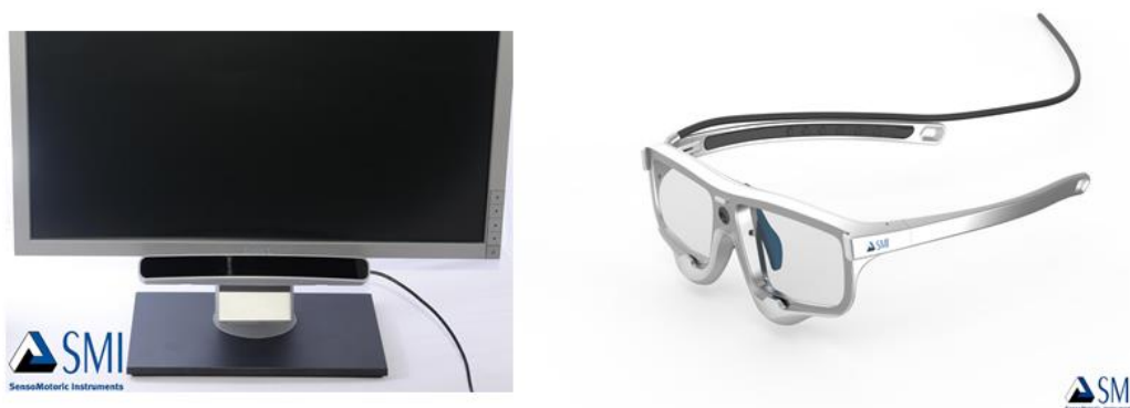
Figure 11 : Oculomètre fixe (à gauche) et portable (à droite) de la compagnie SMI.
