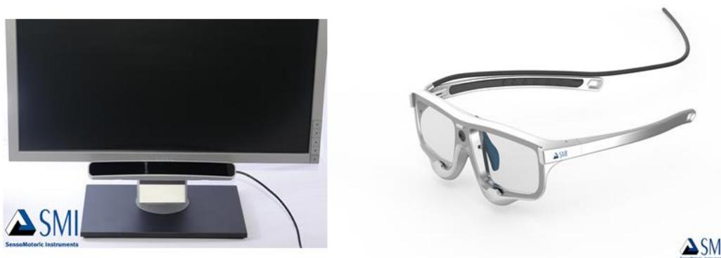
Figure 11 : Oculomètre fixe (à gauche) et portable (à droite) de la compagnie SMI.
