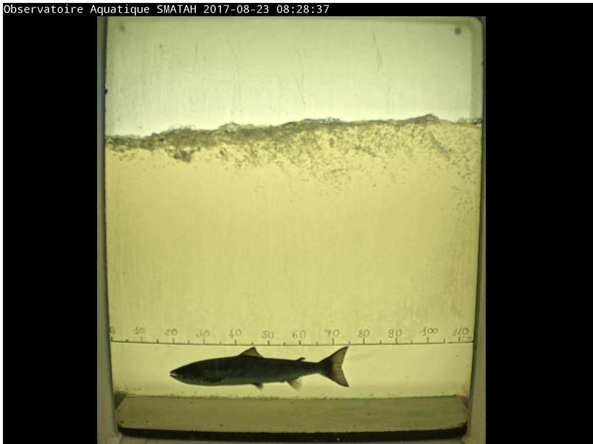
Figure 22: Passage d'un saumon devant la vitre de détection de la station de comptage de Châteaulin (29) (SMATAH - 2017)
