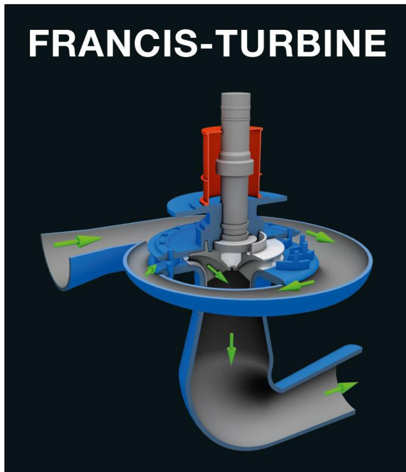
Figure 32: Coupe en 3 dimensions d'une turbine Francis (KWM)
