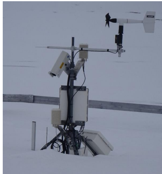
Figure 6: Appareil de mesure de la hauteur de neige à Bayelva (Source: Camille ROGEAUX, mai 2017)
