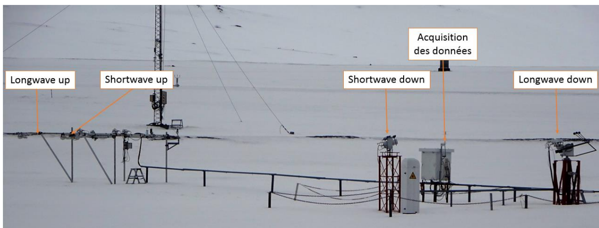
Figure 5: Appareil de mesure des radiations (source: Camille ROGEAUX, mai 2017)
