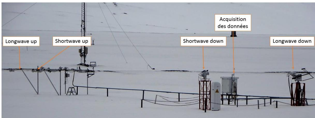
Figure 5: Appareil de mesure des radiations (source: Camille ROGEAUX, mai 2017)
