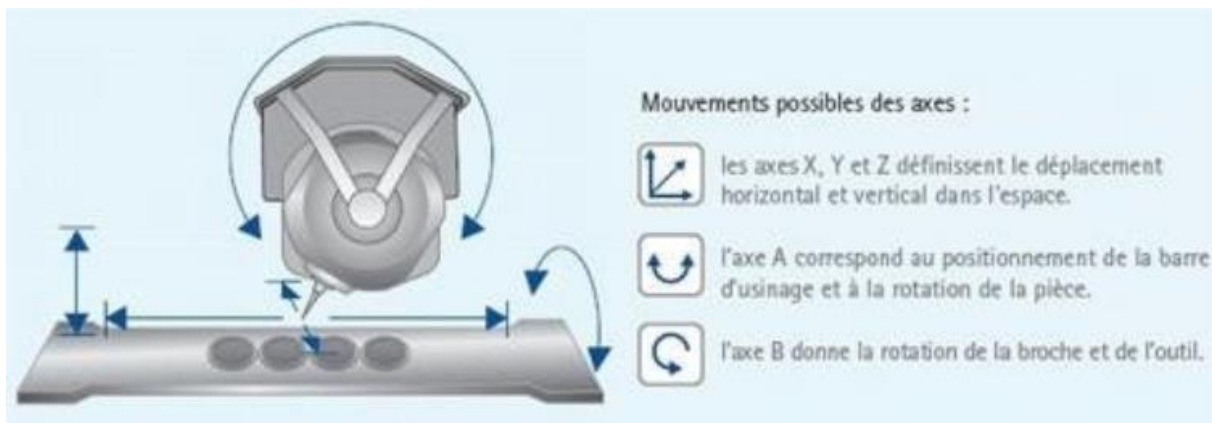
Figure 26 : Exemple de mouvements sur 5 axes sur la machine Everest de Kavo® (72)
