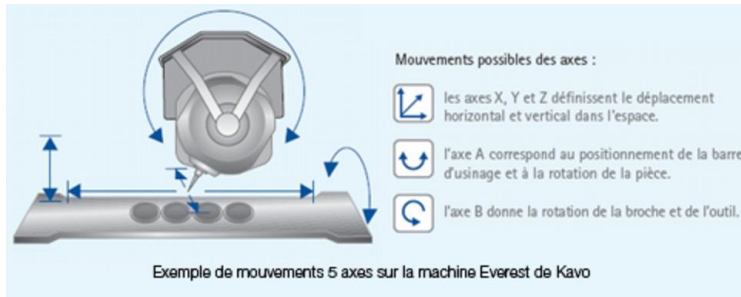
Illustration 4 : Les 5 axes d'usinages[28]
