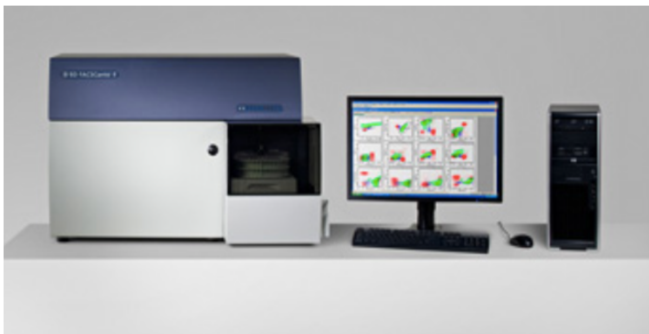
Figure 6 : Cytomètre BD FACSCANTO (à gauche) et logiciel FACSDiva Software (affiché à l'écran) ( bdbiosciences.com )
