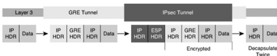
Figure 18 : Encapsulation des données via GRE puis via IPsec
