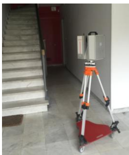
Figure 13 : Scanner LEICA HDS 7000 lors d'un levé
