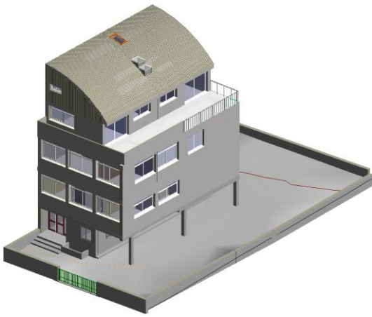
Figure 21 : Maquette BIM des bureaux du cabinet placée dans son contexte, c'est à dire avec MNT et limite de propriétés, visualisation dans Revit.
