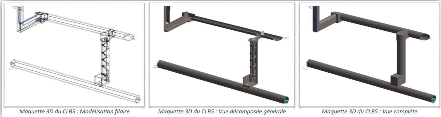
Figure 8 : Modélisation 3D de l'émissaire n°5 du SIAAP au 60 Quai de Seine à Saint Ouen rejoignant l'usine de Clichy-la-Briche
