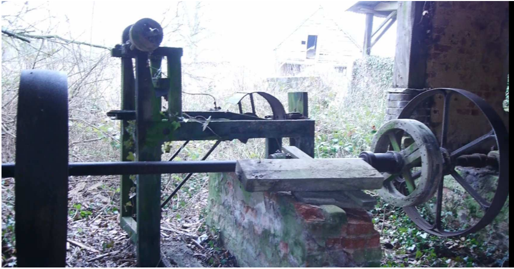
Transmission autrefois reliée au moteur et la lame de scie de la Scierie Saussereau-Richard
