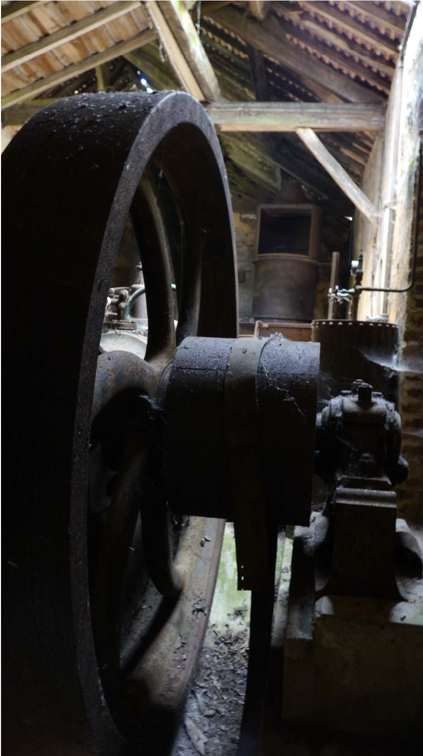
Volant du moteur à gaz pauvre de la Tuilerie des Saules.
