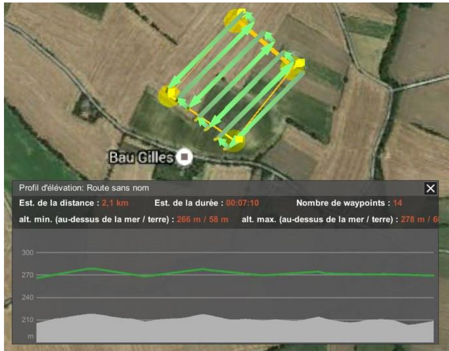
Figure 6: Profil d'élévation issu du logiciel UgCS
