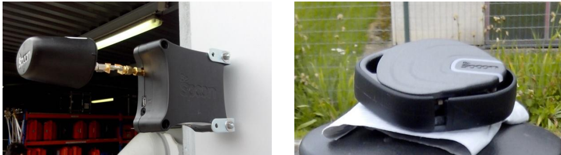
Figures 21.1 et 21.2 : ancre avec fixation magnétique (dimensions 23 x 7 x 4 cm) et tag (dimensions 3 x 3 x 1 cm). Le centre de mesures de l'ancre se situe à l'extrémité de la pièce supportée par la tige métallique.
