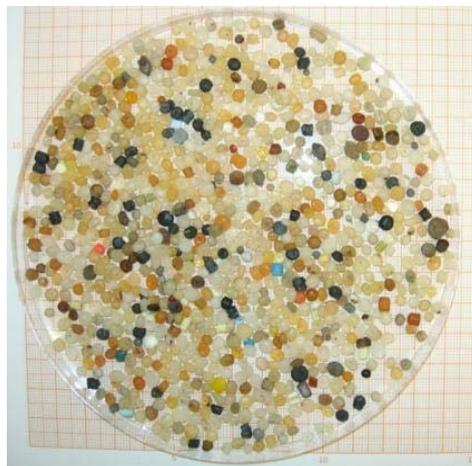
Figure 16: Granulés plastiques industriels - Source: Colasse L. 2011
