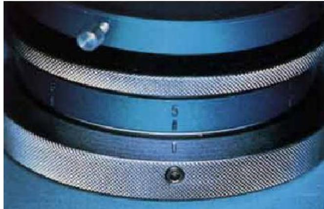
Figure 25 : Bague de réglage du Konator (PROBST, 1988)(33)
