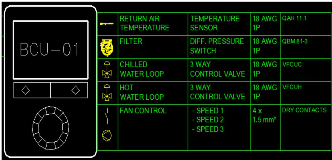
Figure 17: Le 'cable schedule' de l'unité de contrôle 'RDG100.KN'.
