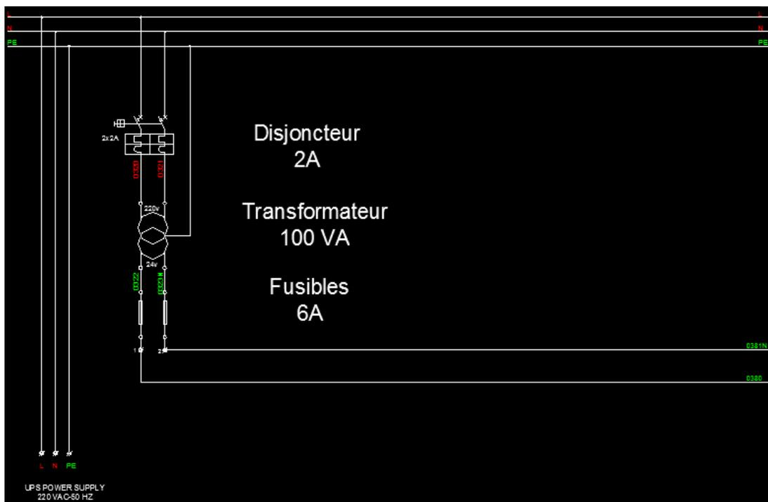
Figure 63: Schéma de câblage des dispositifs de protection.
