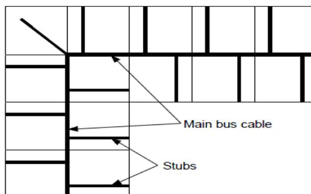
Figure 73: Structure d'un bus de communication.
