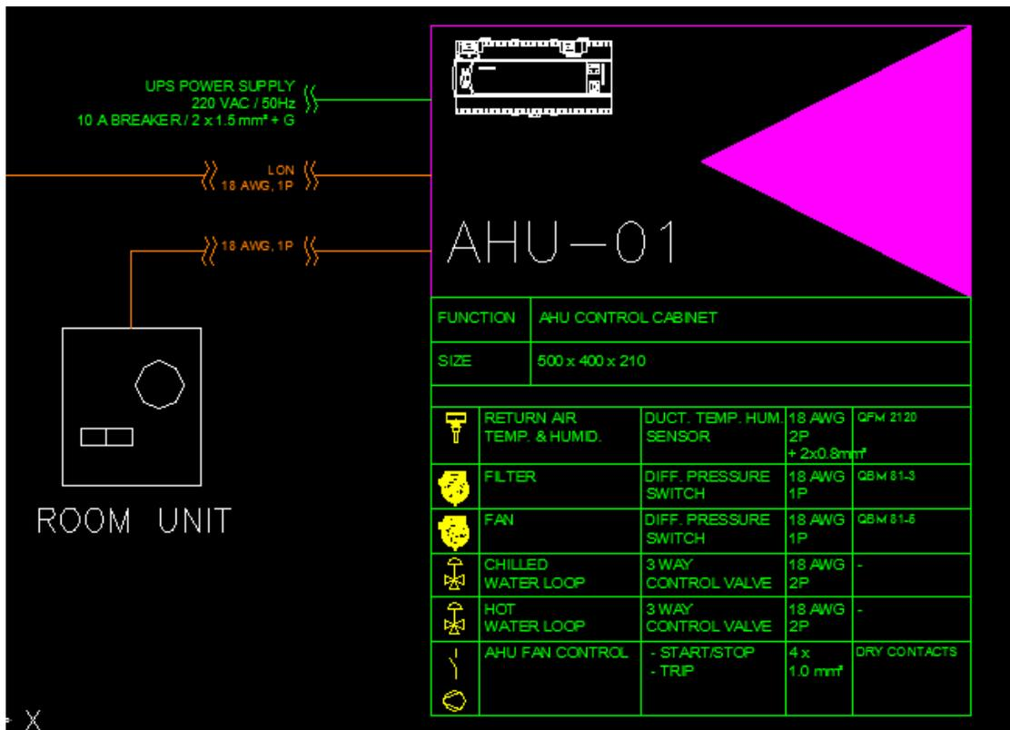
Figure 16: Le 'cable schedule' d'un contrôleur 'PXC12.D'.
