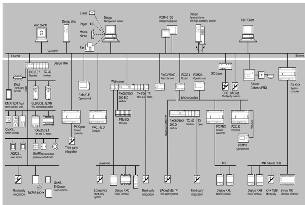
Figure 67: La topologie du système Desigo.
