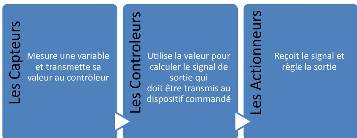
Figure 2: Les éléments principaux d'un système de contrôle.
