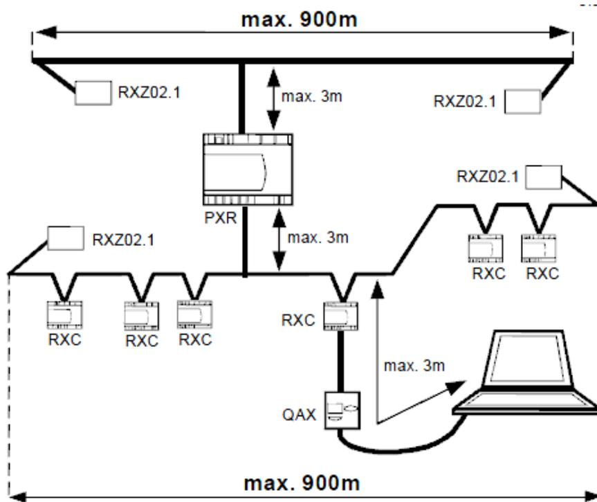
Figure 74: Un bus de communication LonWorks ayant une topologie ligne.
