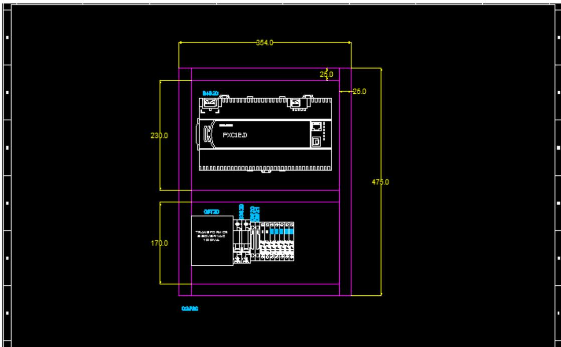
Figure 13: Le schéma d'un tableau électrique revenant à un AHU.
