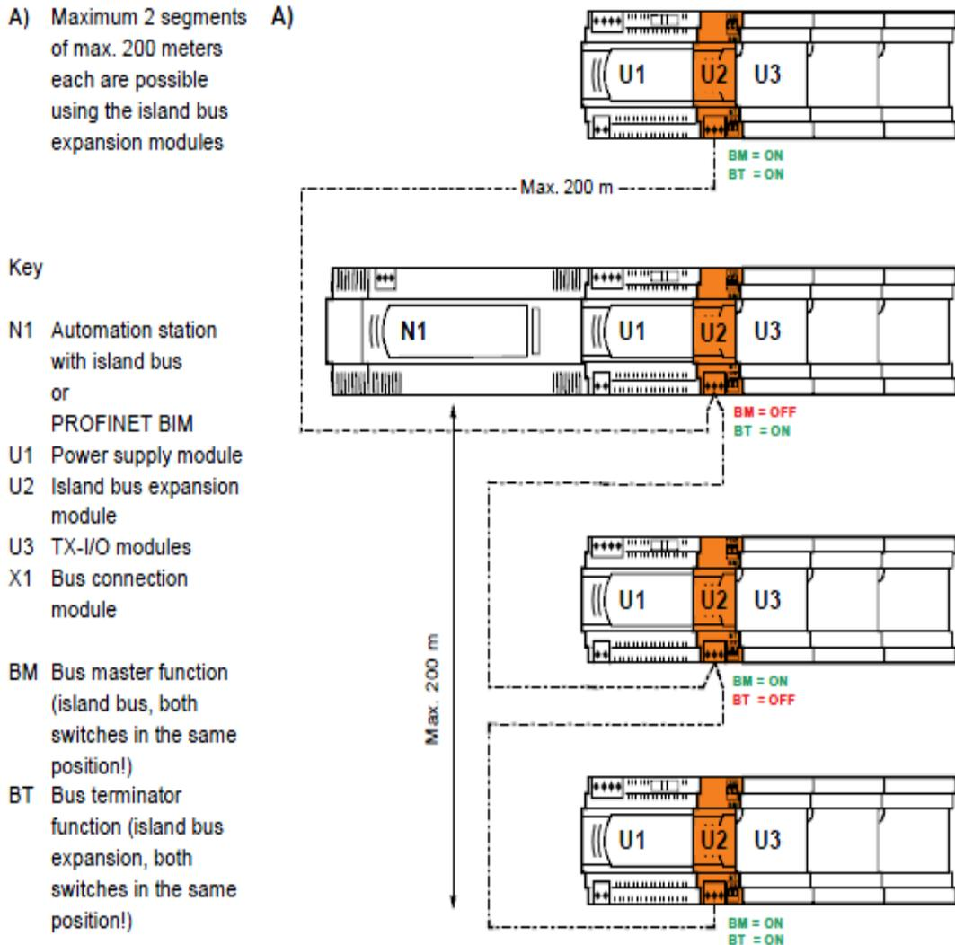
Figure 39: Exemple de connexion du module 'TXA1.IBE'.
