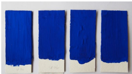
Illustration 19: Échantillons préparés à base de résine de polyacétate de vinyle additionnée de plastifiant (phtalate de dibutyle) et du pigment bleu outremer. A gauche le témoin. Trois échantillons ayant subi un cycle de vieillissement artificiel
