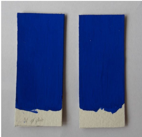
Illustration 21: Échantillons préparés à base de polyacétate de vinyle et de bleu outremer : témoin à gauche et à droite échantillon ayant subi un cycle de vieillissement artificiel. La couche picturale est en très bonne état de conservation.
