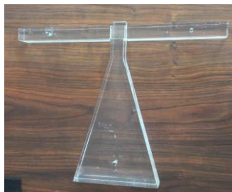
Figure 4: Cale de positionnement des pieds
