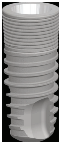
Fig. 8 : Schéma d'un implant autotaraudant, à macro filet asymétrique sur le corps de l'implant, apex arrondi, micro filetage au niveau cortical
