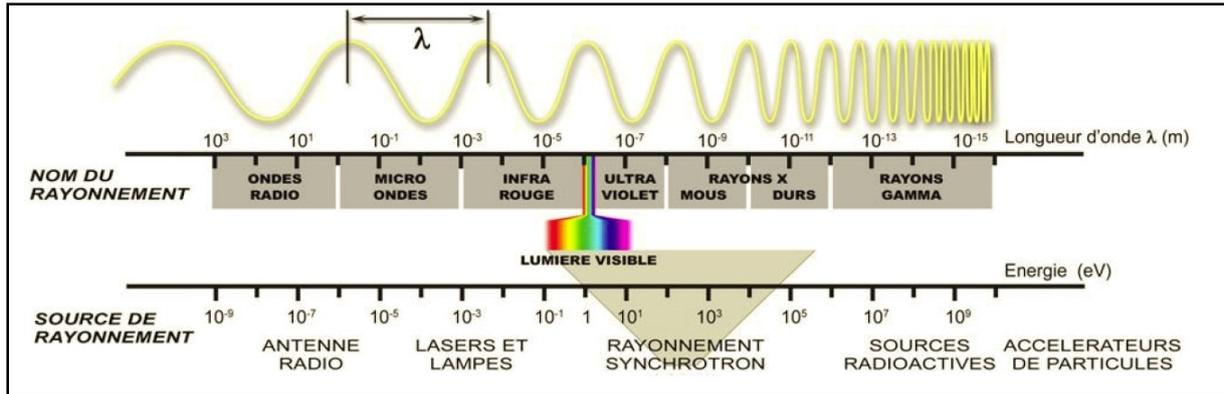
Figure 0-2 Le spectre d'un rayonnement synchrotron [28]
