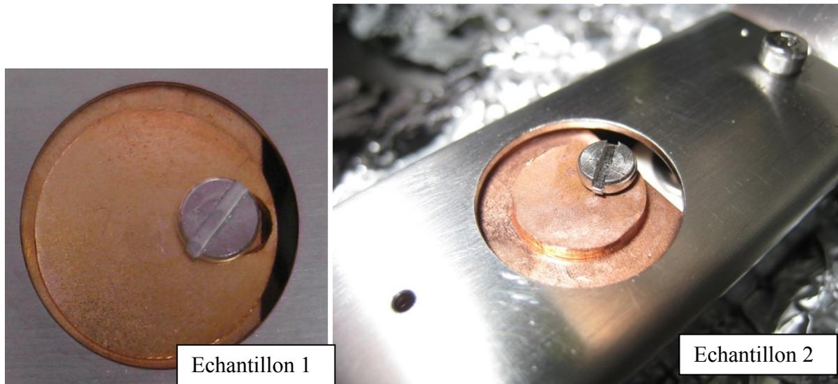
Figure 3-45 Photos des échantillons de cuivre quand ils sont placés dans le porte échantillon
