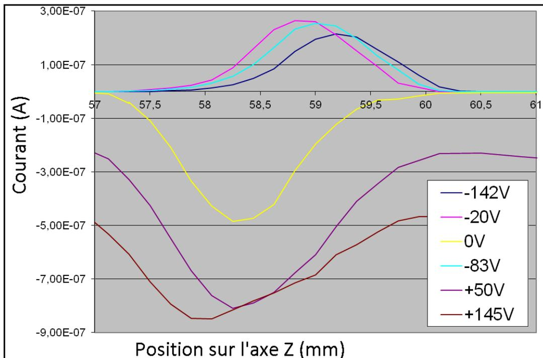
Figure 3-29 Déviation du faisceau en fonction de la tension de polarisation
