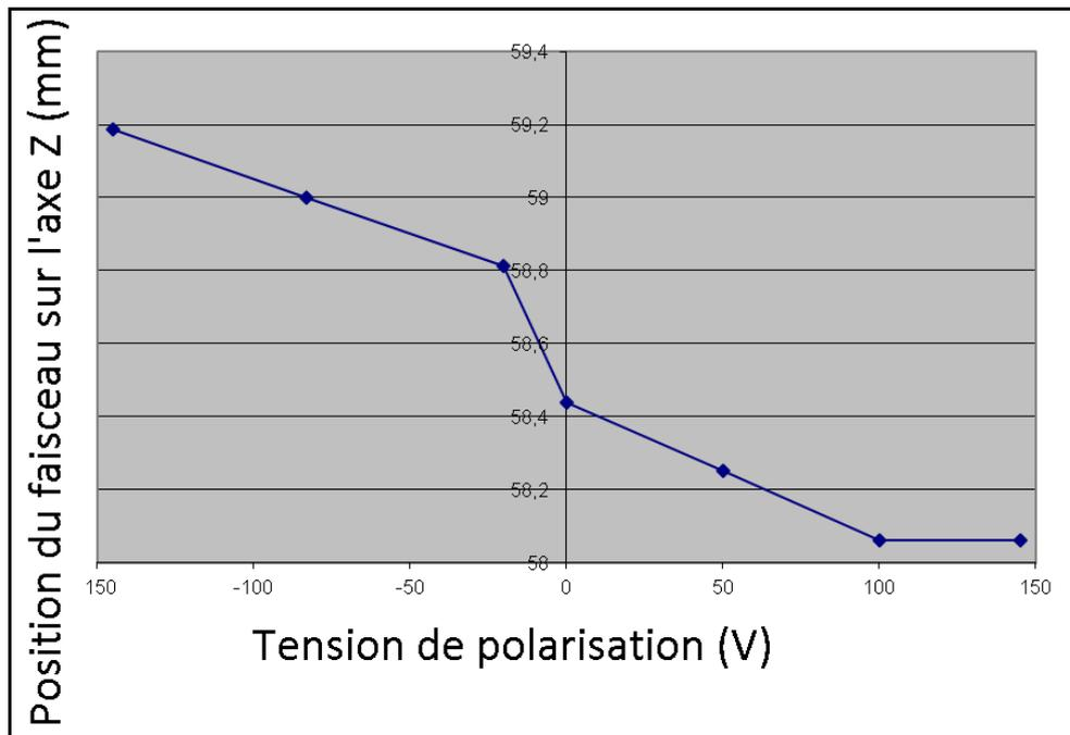
Figure 3-30 Déviation du faisceau en fonction de la tension de polarisation
