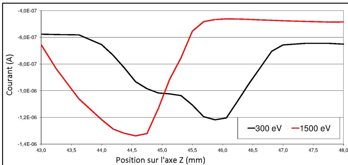
Figure 3-32 Déviation du faisceau selon l'énergie des électrons
