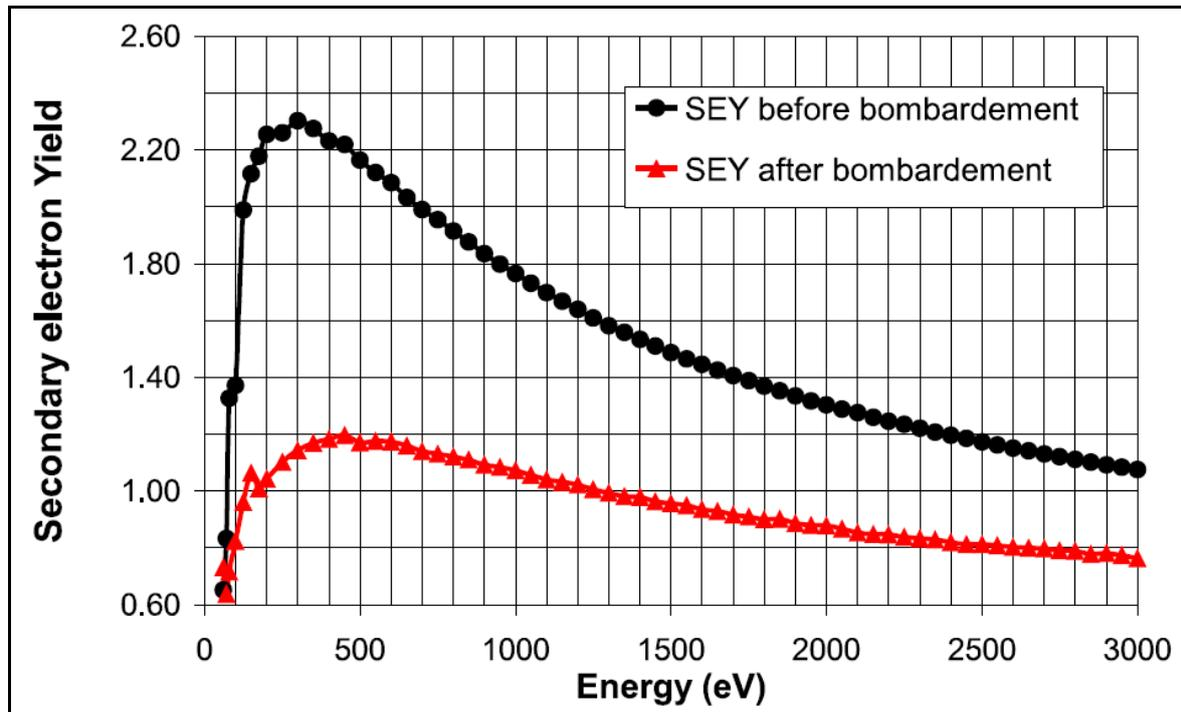
Figure 1-16 Evolution du SEY d'un échantillon de cuivre après avoir reçu une dose d'électrons. La dose est de  $5.10^{-3}\text{ C/mm}^2$  avec des électrons primaires ayant une énergie de 500 eV. [21] [16]
