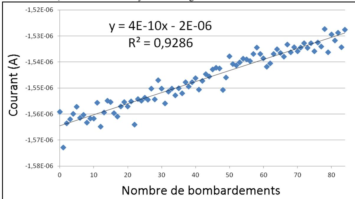
Figure 3-37 Evolution du courant mesuré en fonction du nombre de bombardements (accumulation de doses)
