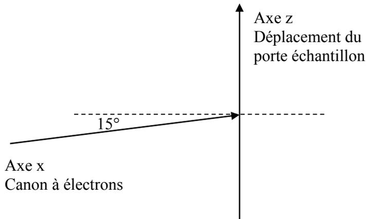
Cela signifie que toutes les distances mesurées selon l'axe de Z de l'enceinte doivent être multipliées par un facteur  $\cos(15^\circ)$  pour obtenir les bonnes distances dans le système axe du canon.
