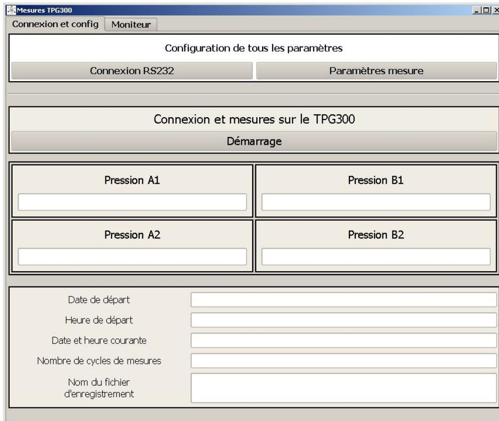
Figure 3-4 Capture d'écran du programme d'enregistrement des pressions
