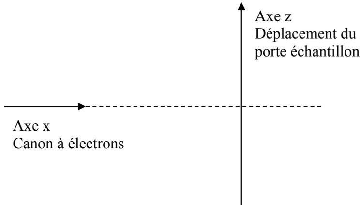
Dans cette représentation vue de dessus, l'axe du canon à électrons et l'axe du porte échantillon sont à angle droit, et ils sont également exactement à la même hauteur (axe y).
