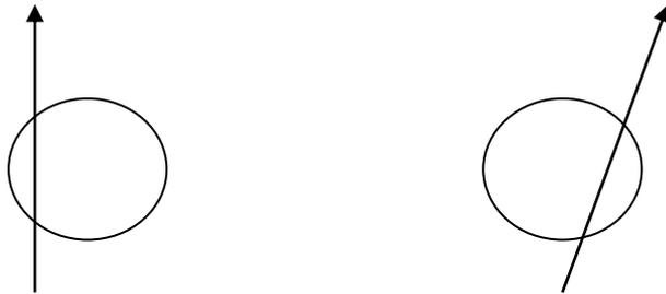
**Figure 3-33 Exemples de déplacements du faisceau selon l'axe Z qui ne sont pas corrects car ils ne passent pas par le centre du trou**
