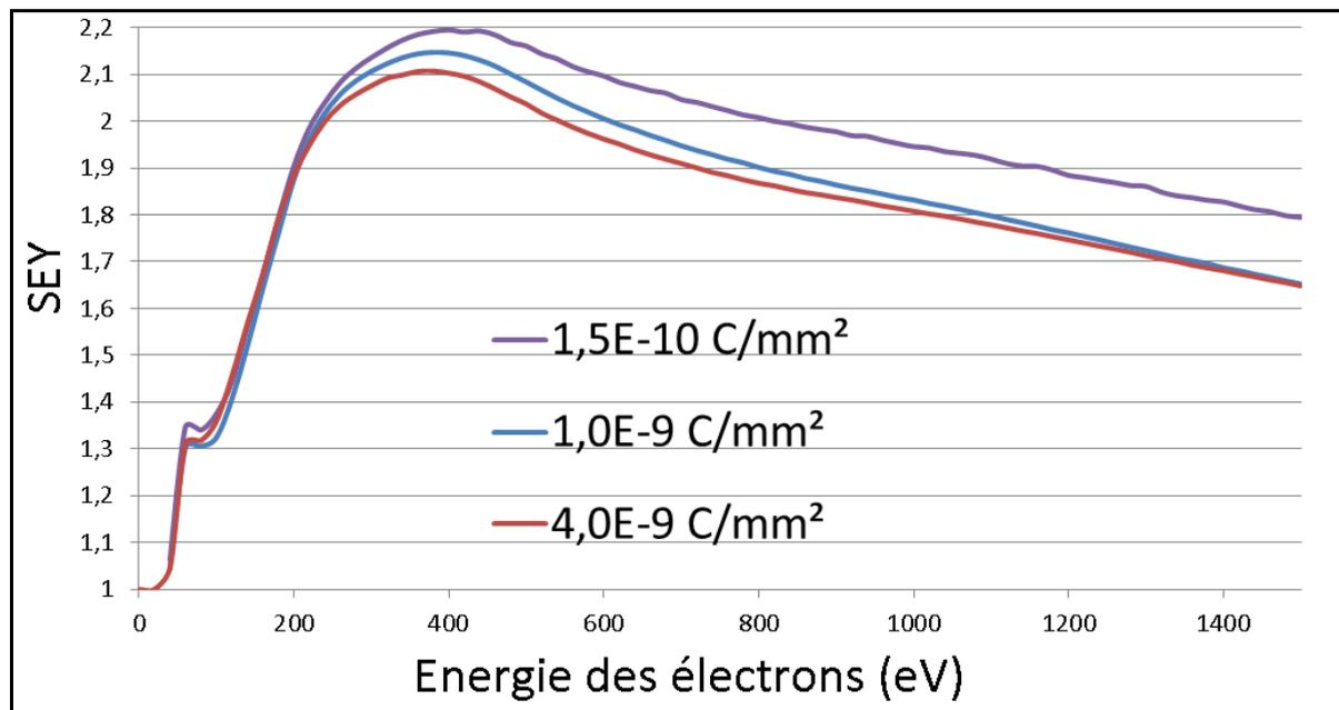
Figure 3-51 Mesures du taux d'émission d'électrons secondaires avec la méthode SLAC sur l'échantillon de cuivre 2
