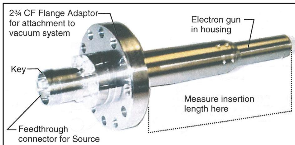
Figure 3-5 Photo commentée du canon à électrons EFG-7
