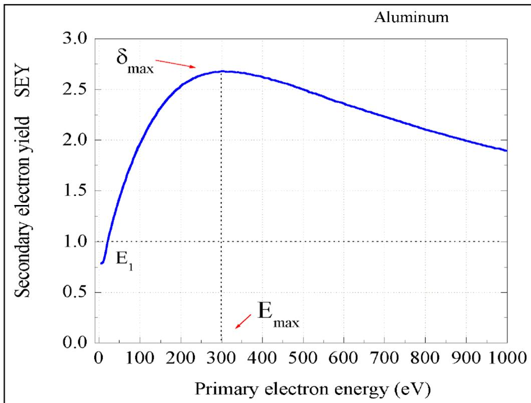
Figure 1-9 Courbe caractéristique d'un taux d'émission d'électrons secondaires [24]
