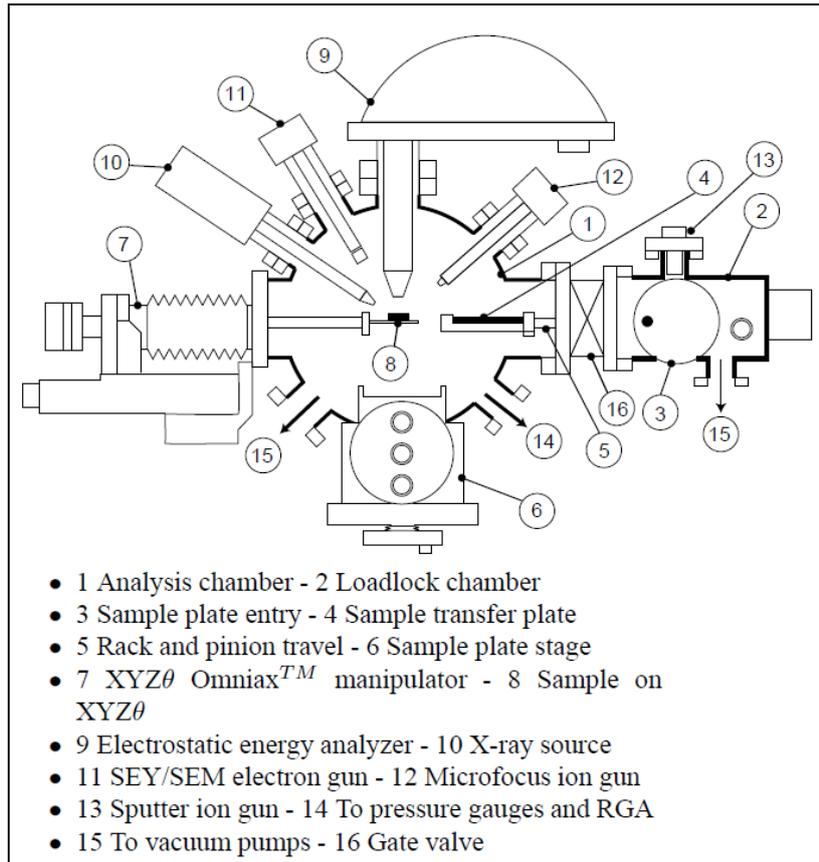
Figure 2-6 Schéma du bâti d'essais du SLAC [11]
