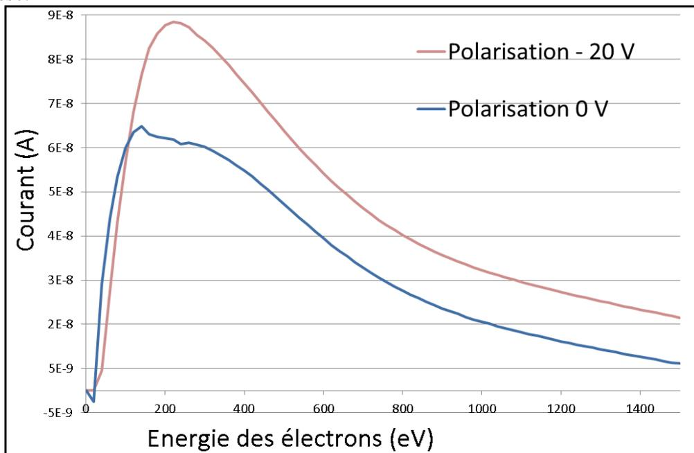
Figure 3-47 Courbes caractéristiques avec la polarisation nulle et négative
