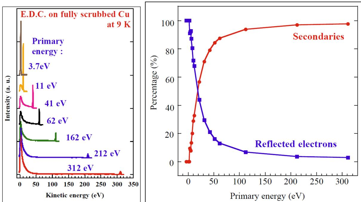
Figure 2-13 Répartition des électrons secondaires en fonction de leur énergie [19]
