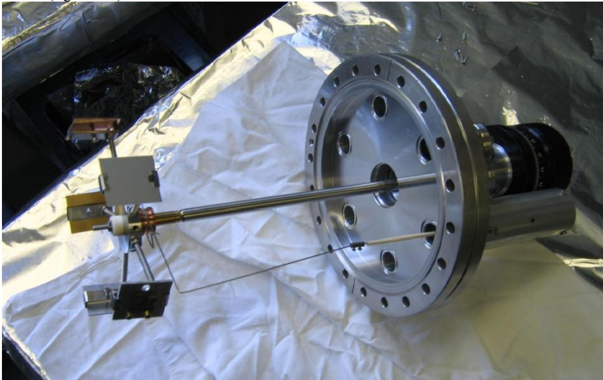
**Figure 4-1**      **Porte échantillons multiple du CERN [37]**
