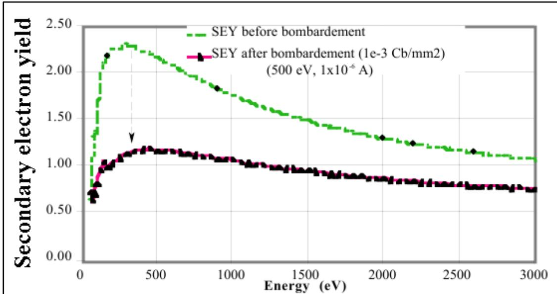
Figure 3-52 Réduction du taux d'émission d'électrons secondaires du cuivre après un bombardement électronique (dose :  $10^{-3}$  C/mm<sup>2</sup>)
