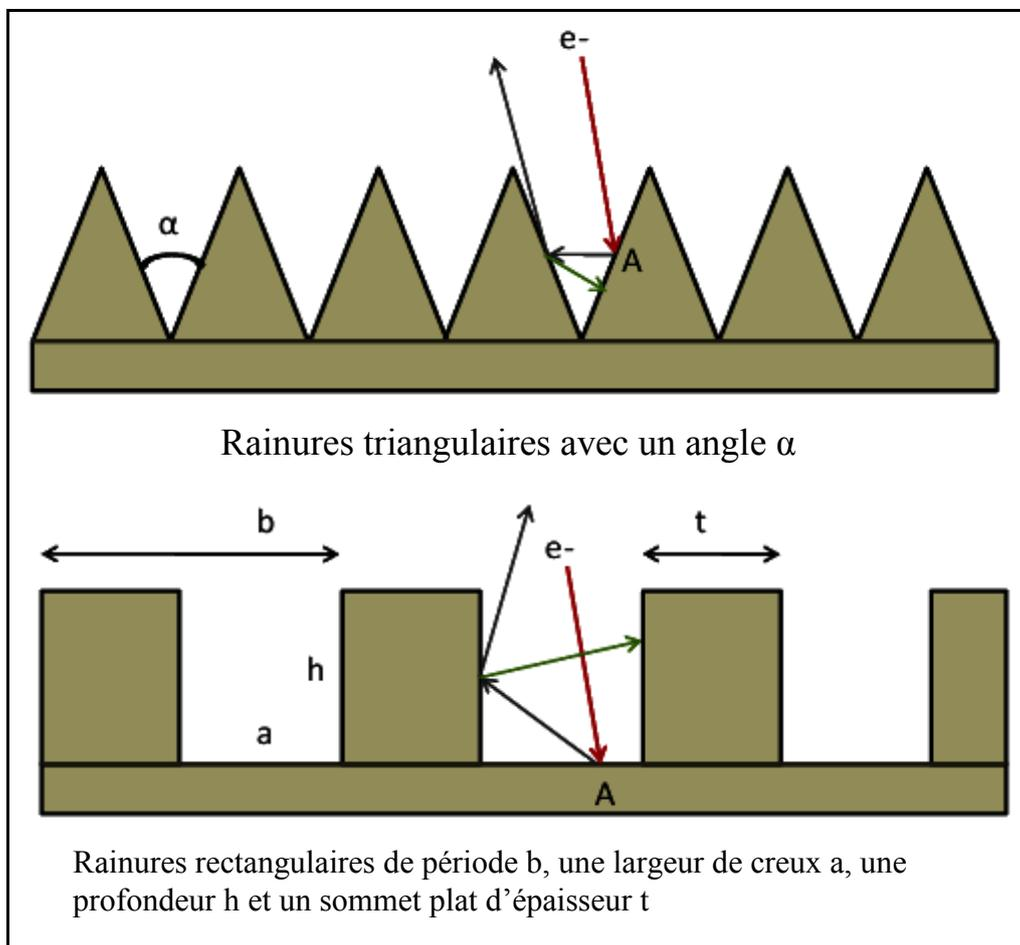
Figure 1-11 Influence de la surface sur le taux d'émission d'électrons secondaires [42]
