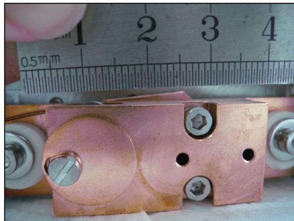
Mesure du taux d'émission d'électrons secondaires d'une surface durant un bombardement électronique
