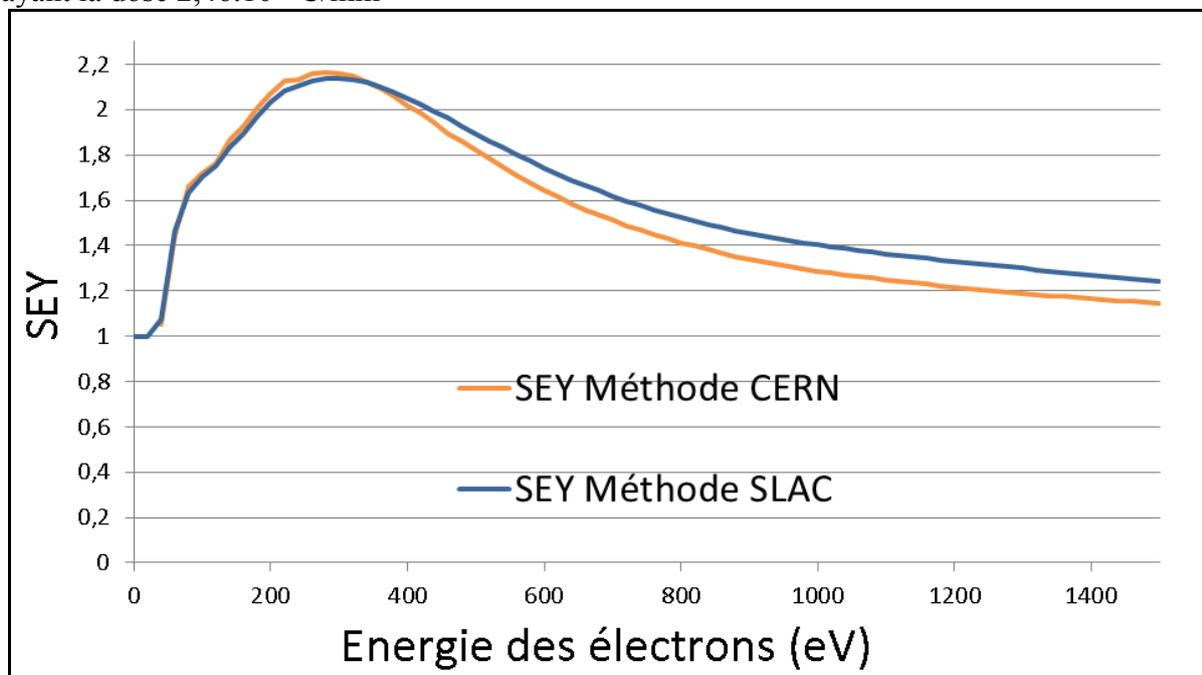
Figure 3-53 Comparaison de nos courbes du taux d'émission d'électrons secondaires en utilisant 2 méthodes différentes (dose  $2 \cdot 10^{-8}$  C/mm<sup>2</sup>)
