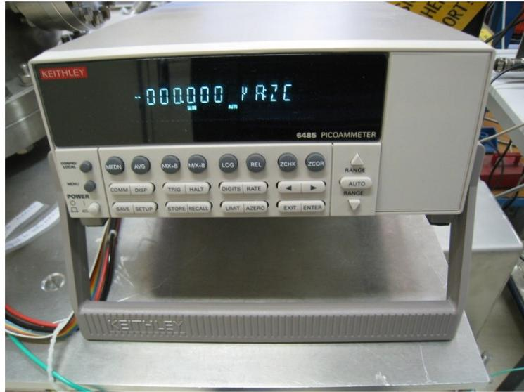
Figure 3-9 Face avant du pico-ampèremètre
