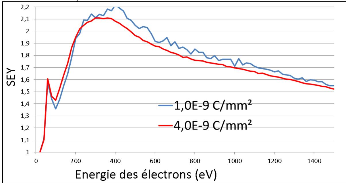
Figure 3-54 Comparaison de nos courbes du taux d'émission d'électrons secondaires en utilisant 2 méthodes différentes (doses  $10^{-9}$  et  $4 \cdot 10^{-9}$  C/mm<sup>2</sup>)
