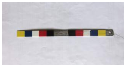
FIGURE 3.3 – Mire de calibration sous éclairage artificiel (protocole 2). Cette photo servira de base pour la calibration des images sous-marines. Photo : Pascal Dumas (IRD)
