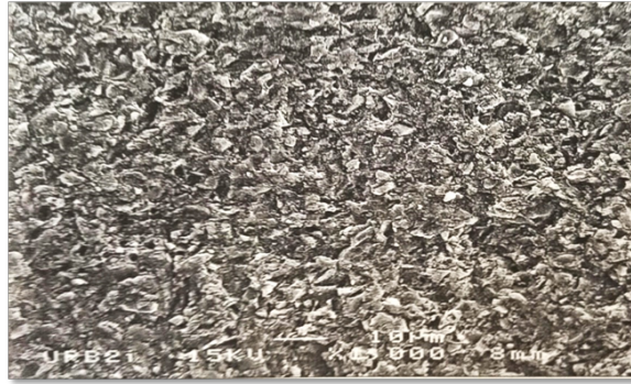
Figure 69 - Surface de l'Enamic ® après sablage (M.E.B) (Nguyen JF et al. 2014) Le sablage n'est cependant pas nécessaire pour l'Enamic ® qui possède une phase vitreuse.
