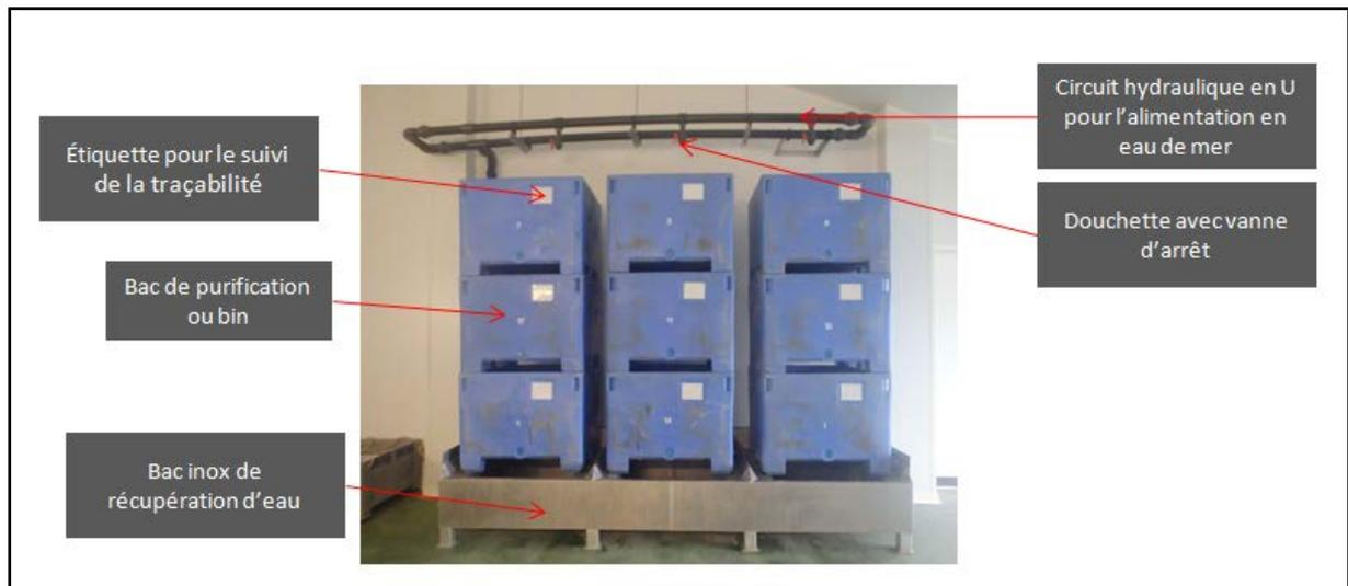
**Figure 6 :** Disposition du système de purification des moules
