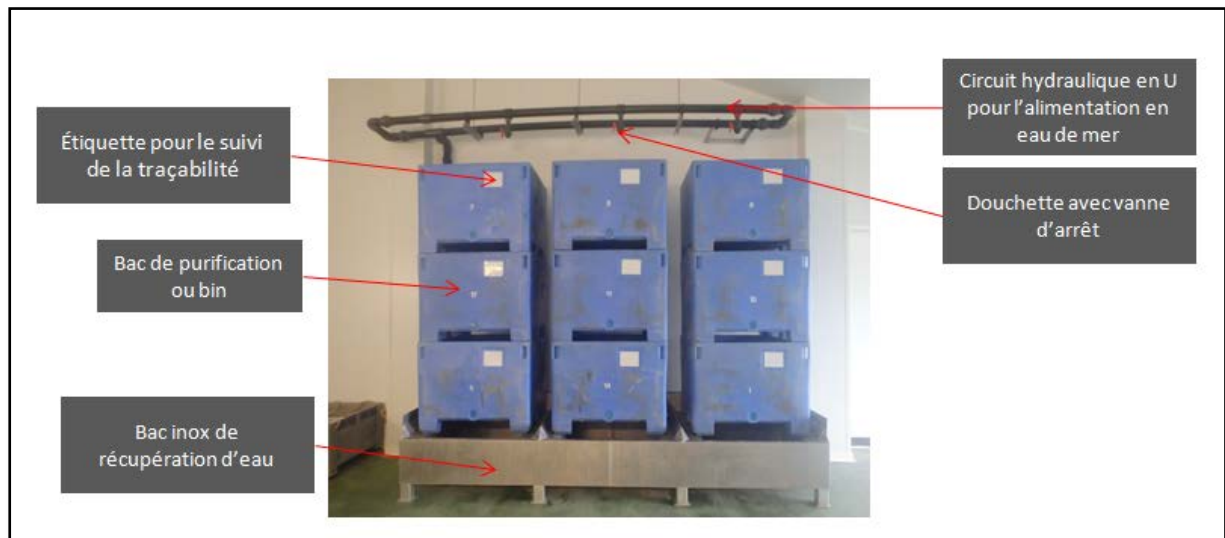
Figure 6 : Disposition du système de purification des moules
