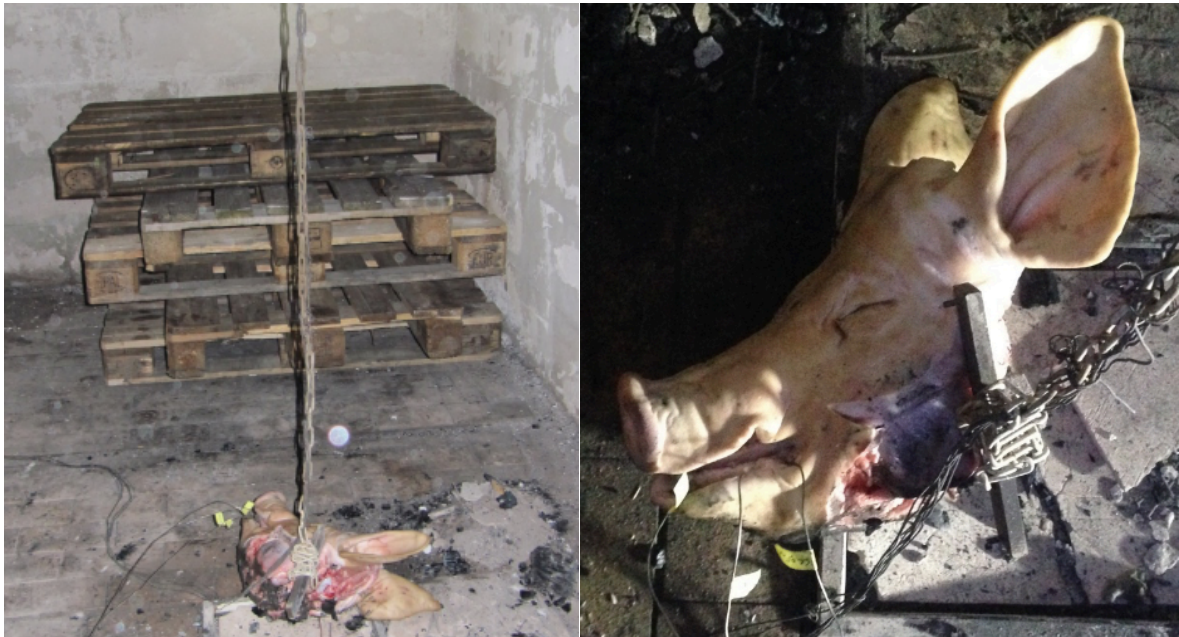
Figure 35 : Tête 1 à 50 cm du foyer au sol, orientée couche feu avec thermocouples en place.
