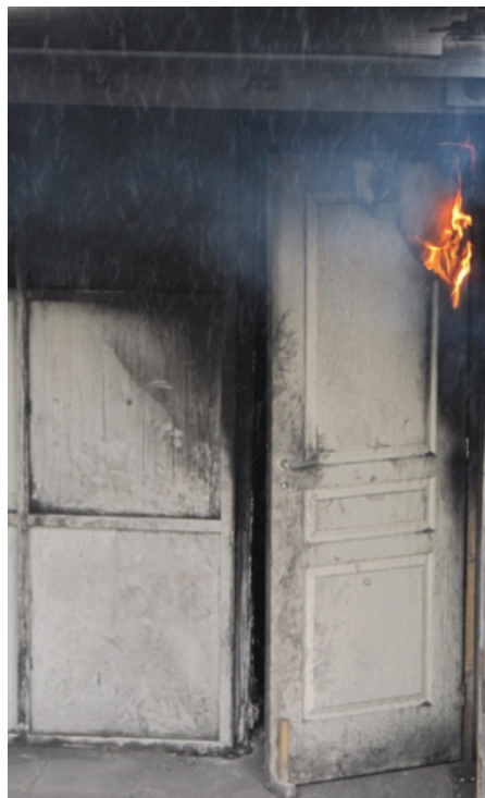
Figure 39 : Porte ouverte, située à 11,73 m du foyer de l'incendie, qui prend feu 20 minutes après l'allumage.
