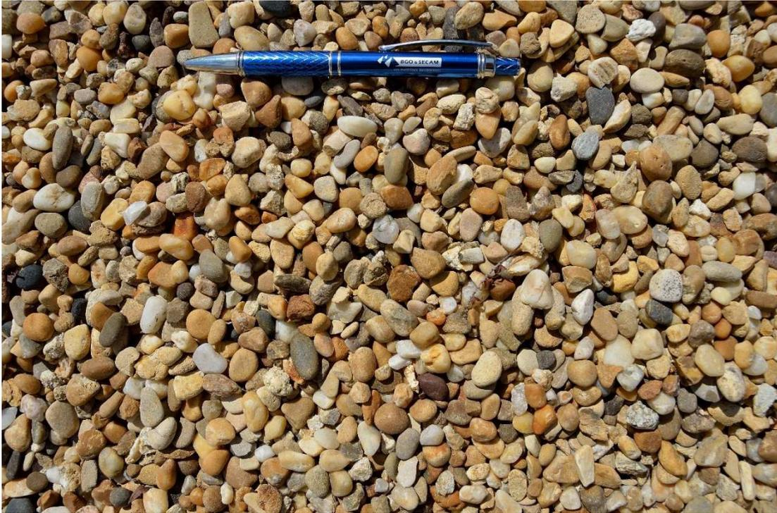
*Figure 3 : granulats roulés et semi-roulés (quelques faces cassées)*
