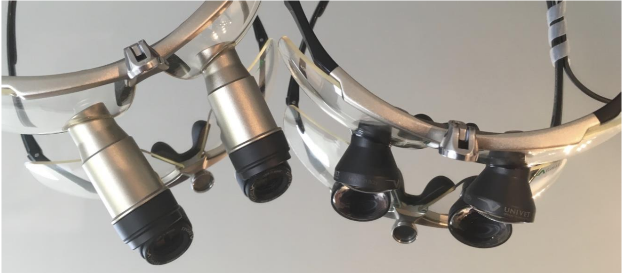
Fig. 20- Loupes binoculaires (photo du Dr Moll). A gauche : loupes de Kepler (4x). A droite : Galiléenne (2.5x).
