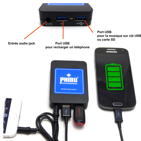
Figure 21 : Exemple de détrompeur de contact : USB
