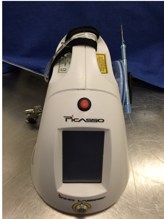
Figure 2: laser diode utilisé pour traiter les surfaces des disques utilisés pour les manipulations. Crédit photo A. Lassus
