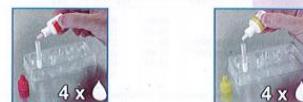
Déposer 4 gouttes de réactif A puis 4 gouttes de réactif B dans le tube d'extraction
