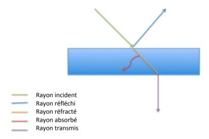
Fig. 3: Interaction du rayon incident avec l'interface entre deux milieux
