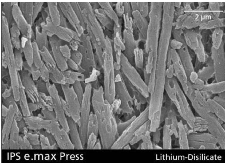
Fig. 24 : Structure e.Max<sup>®</sup> Press (MEB)
