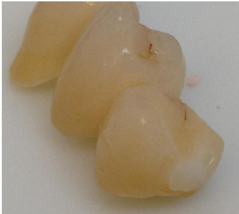
Fig. 31 : Fracture de la connexion en zircone
