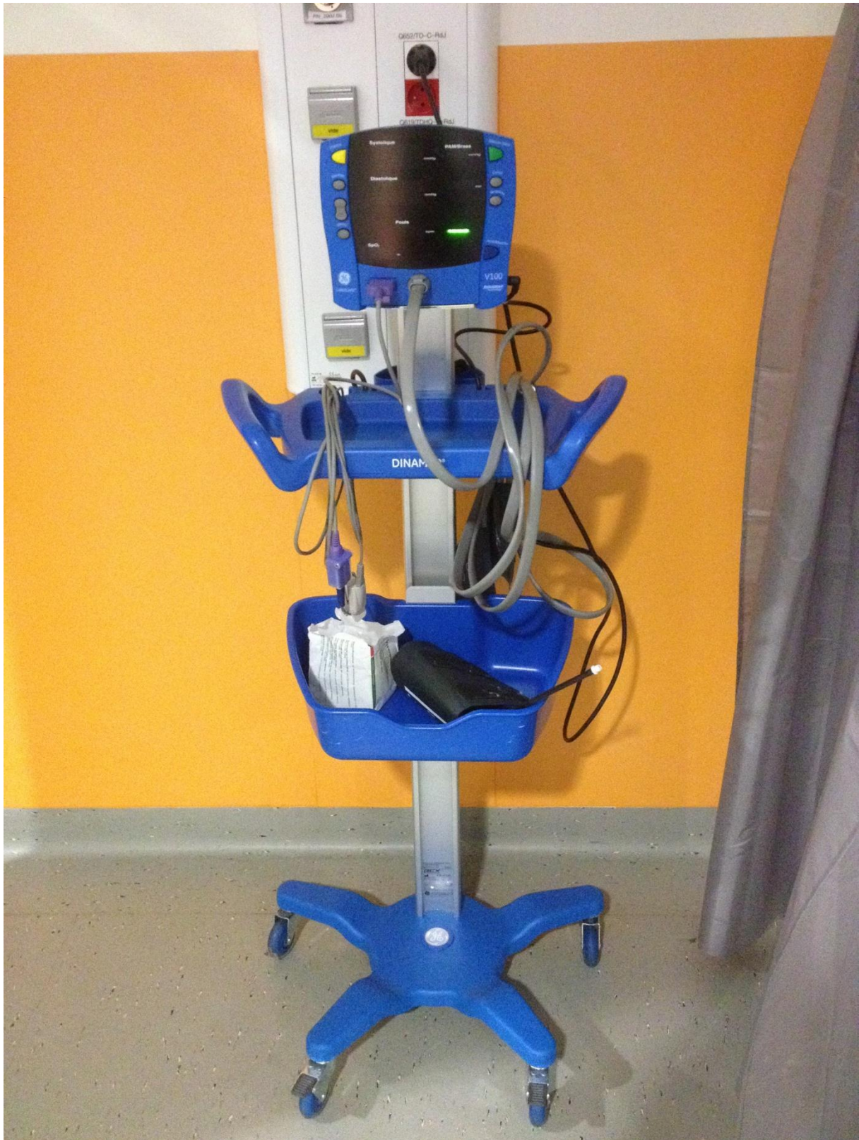
PHOTO 1 : Appareil de mesure validé de pression DINAMAP avec afficheurs 7 segments pour l'affichage direct des paramètres de tension systolique, diastolique et moyenne; fréquence cardiaque.
