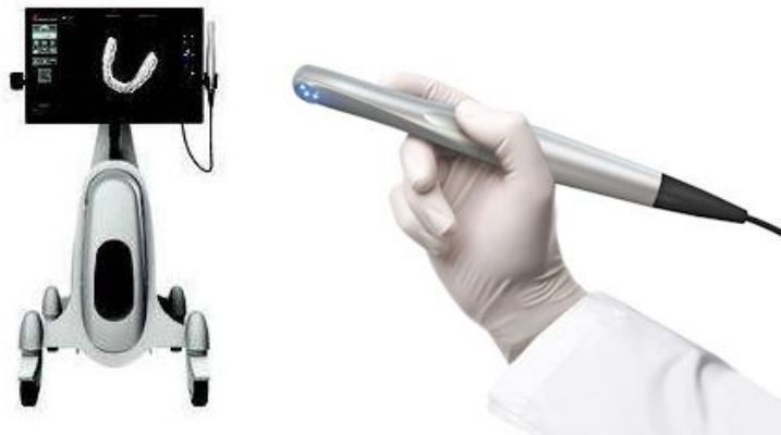
Figure 44 : Poste de travail et caméra du système Lava True Definition
