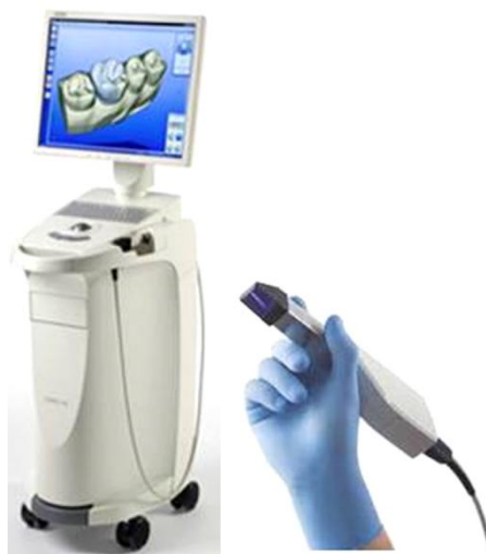
Figure 24 : Poste de travail CEREC et caméra Bluecam
