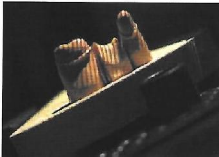
Figure 11: Projection de bandes d'un motif sur un modèle en plâtre
