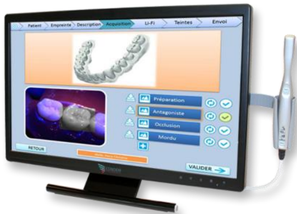
Figure 52 : Caméra Condor Scan associé à l'écran d'ordinateur
