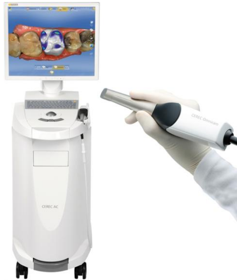
Figure 32 : Poste de travail CEREC® et caméra Omnicam
